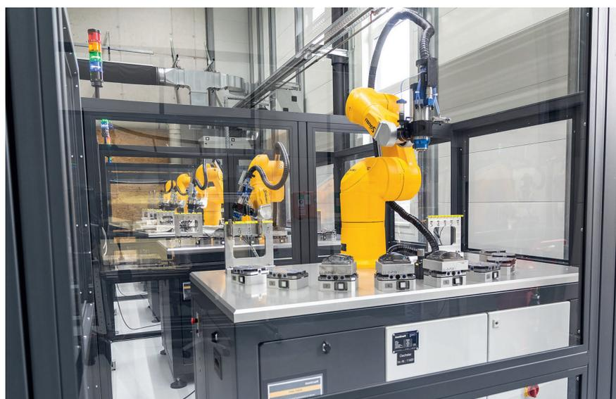
3 Fünf Stäubli-Roboter polieren die Keramikspangen. Die Präzision der Bearbeitung wird durch die Werkzeuglängenmessung mit dem Werkzeug-Messtaster Z-Nano gewährleistet
