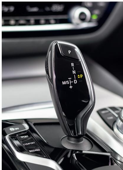
2 Gangwahlhebel mit Keramikspange, die automatisiert poliert wird (© Blum)
