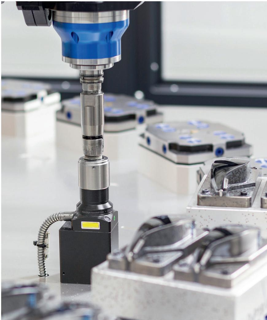
1 Das Filzwerkzeug nutzt sich schnell ab, deshalb wird vor jedem Poliervorgang mit dem Tastkopf Z-Nano die aktuelle Werkzeuglänge gemessen (© Blum)
