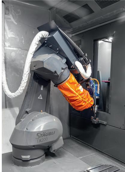
4 Die Präzision der Fräsbearbeitung mit dem Roboterarm hängt ganz entscheidend von der regelmäßigen Werkzeugmessung mit dem Lasermesssystem LC50-Digilog ab (© Blum)
